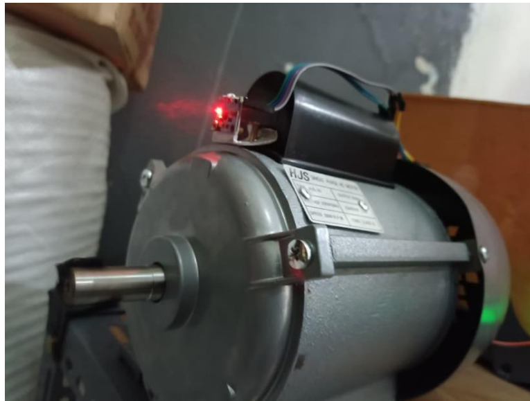
Gambar 2. Posisi pemasangan sensor MPU6050 pada arah radial vertikal.
