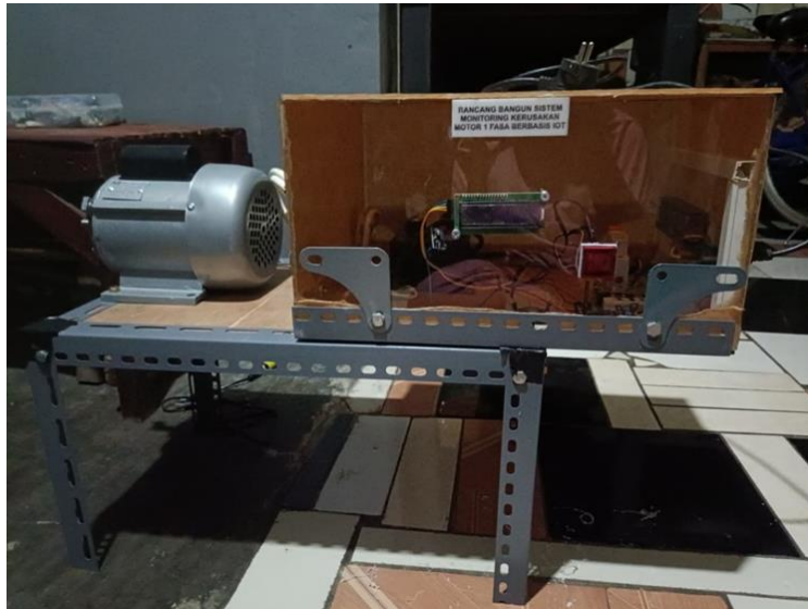
Gambar 11. Implementasi perangkat monitoring pada motor satu fasa.
