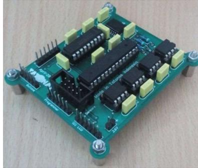
**Gambar 9. Purwarupa sistem elektronik pengendali utama piranti perekam digital rendah daya.**
