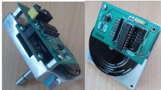
**Gambar 8. Purwarupa sensor pengukur tinggi muka air jenis pelampung yang menggunakan konsep penyandian putar.**
