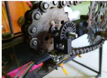
**Gambar 6. Penempatan optocoupler**
