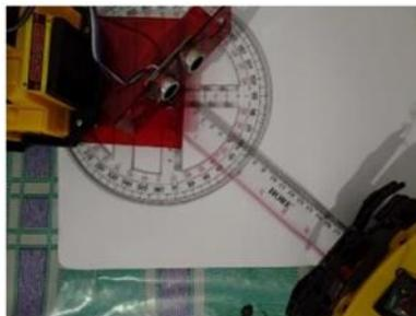
Gambar 15. Pengujian Radar Ultrasonik
