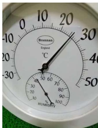
**Gambar 6.** Bentuk fisik Termometer Analog dan Pengukur Kelembaban
