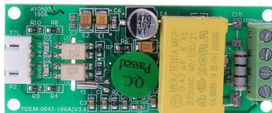
**Gambar 3.** Sensor Tegangan, Arus dan Frekuensi PZEM-004T
