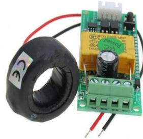
**Gambar 3.** Sensor Arus, Tegangan dan Frekuensi
