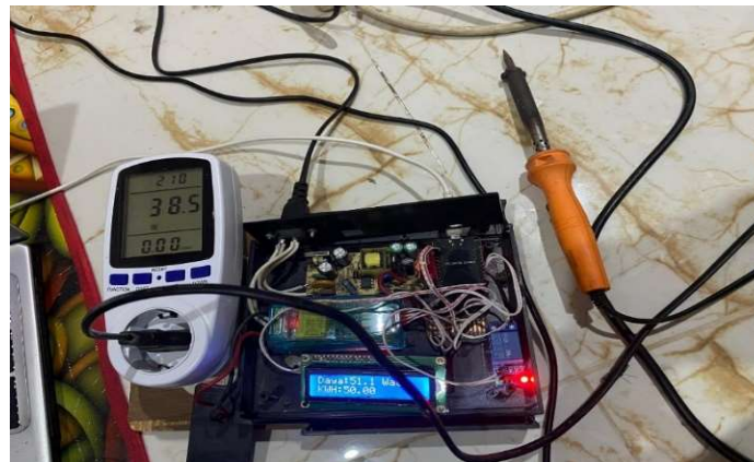
Gambar 12. Pengujian sensor PZEM014 menggunakan beban solder 40 Watt
