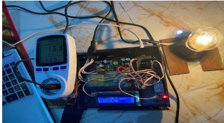
Gambar 10. Pengujian sensor PZEM014 menggunakan beban solder 15 Watt
