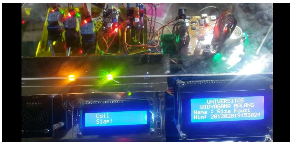
Gambar 7 Menampilkan lampu led indikator dan lcd bahwa coil siap
