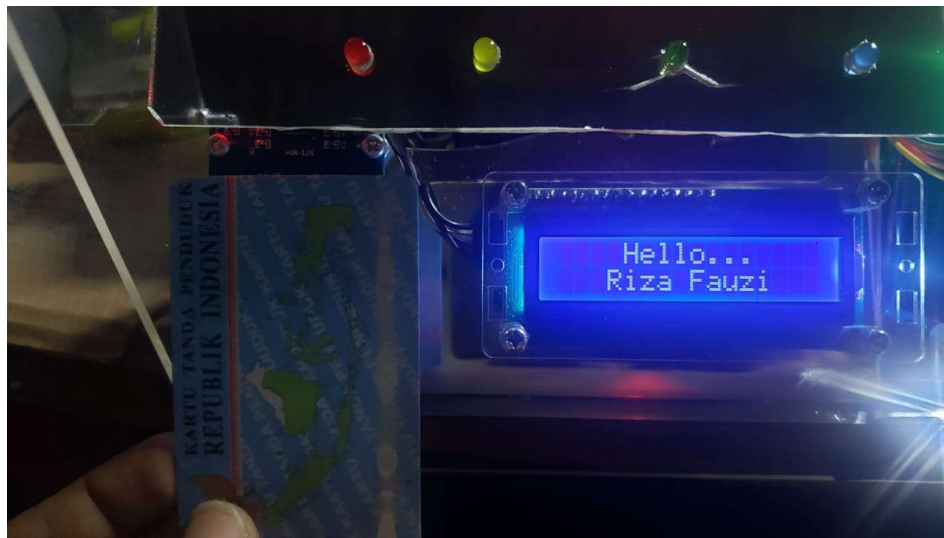
Gambar 5 Menampilkan E-KTP saat discanning oleh RFID Reader
