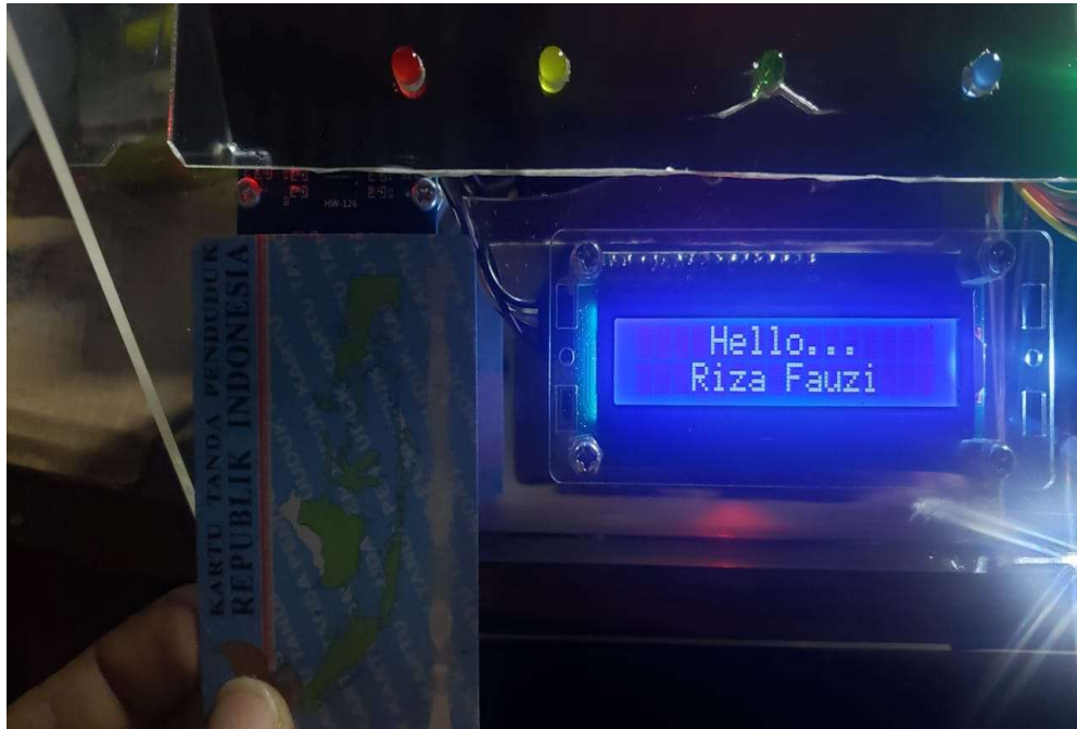
Gambar 4 Pengujian RFID Reader dengan E-KTP
