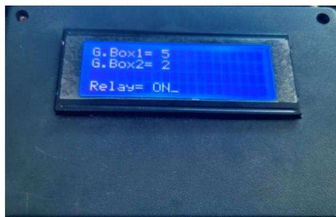
Gambar 11 Relay ON pada LCD saat counter 2 kurang dari counter 1
