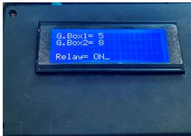
Gambar 10 Relay ON pada LCD saat counter 1 kurang dari counter 2
