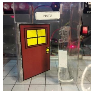
Gambar 11. Input pintu terbuka pada sensor MC38 dan alarm aktif.
