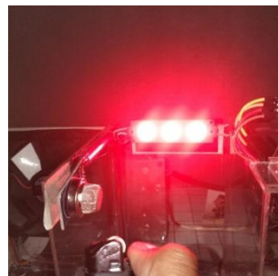
Gambar 9. Input gas melebihi batas aman pada sensor MQ-4 dan lampu darurat aktif.
