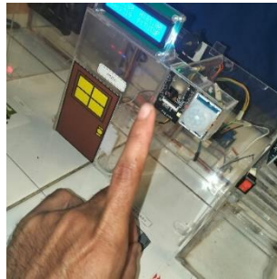
Gambar 15. Input gerakan pada sensor PIR
