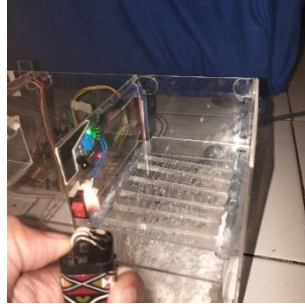
Gambar 13. Input api pada sensor KY026 dan pompa air aktif.
