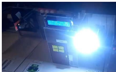
Gambar 16. ESP 32CAM mengambil gambar kemudian mengirimkan notifikasi ke email.
