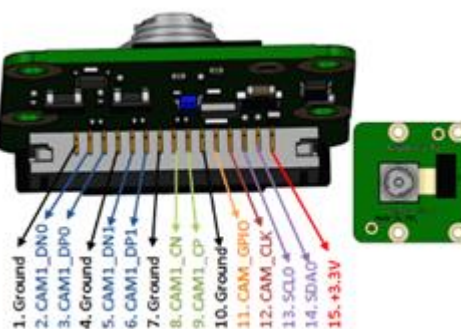
Gambar 2. Urutan Pinout Camera Module
